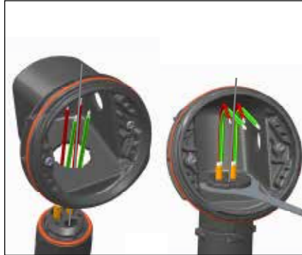
11. 정션 박스 베이스를 익스페디터에 장착합니다. 정션 박스 베이스가 올바르게 배치되도록 슬롯을 정렬합니다. Terminator-LN-도구로 너트를 조입니다. 수평으로 장착하는 경우 스레드 글랜드 구멍이 아래를 향해야 합니다.
