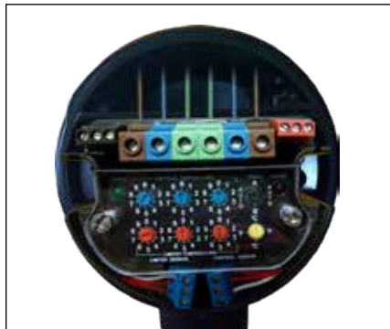
14. 전기 제어 모듈을 설치하고 시스템 결선을 완료합니다. 터미널 세트 나사는 1.4Nm(12.4lb-in)의 토크로 조여야 합니다. 결선 세부 사항을 참조하시기 바랍니다. 전자 제어 모듈 또는 제어 리미터를 원하는 설정점에 설정합니다.
