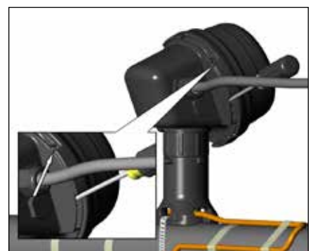
18. 캡 래치 장치가 완전히 잠깁니다. 캡을 제거하려면 단계 16 및 17을 반복하되 반대 방향으로 실시합니다.
